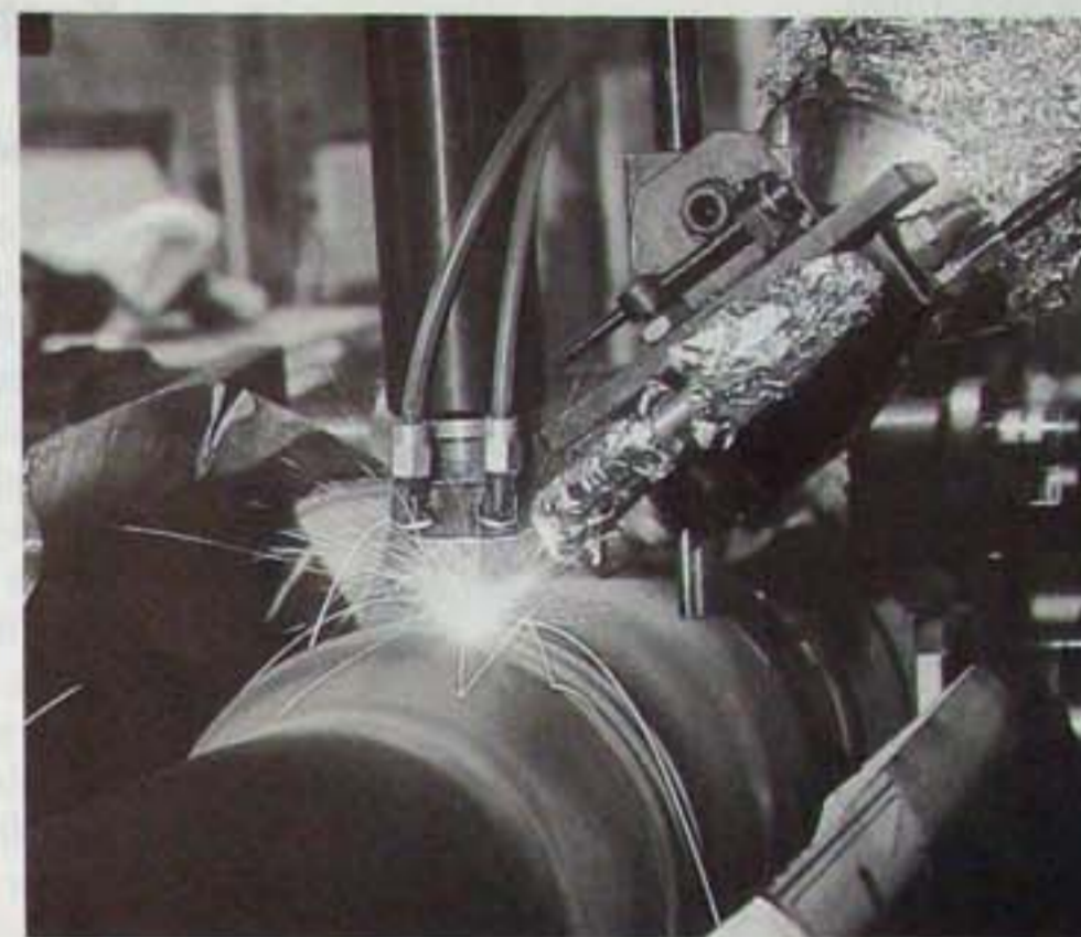
Trattamento con laser di aste di perforazione.
